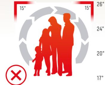
Raumluft wird erwärmt und steigt auf, wobei der Fußboden kalt bleibt. Heizungsluft wird durch Konvektion (Wärmeströmung durch Temperaturunterschiede) vom Fußboden zur Decke transportiert, die Ecken werden dabei ausgespart und bleiben kühler. Die Luftströmung wirbelt zudem Staub, Milben und Bakterien auf. Mögliche Folgen sind Kondensation, Schimmel und Allergien.
