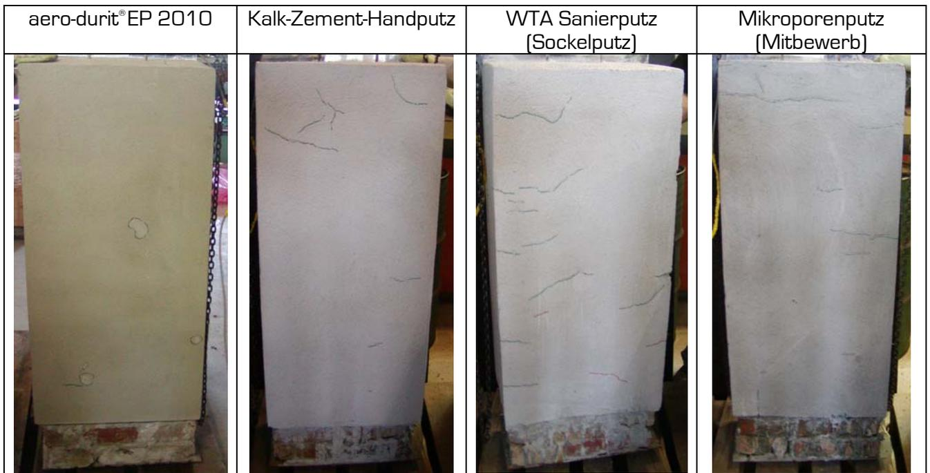
Es zeigte sich, dass der mit aero-durit® EP 2010 verputzte Pfeiler, nahezu rissfrei blieb, wohingegen sich bei den anderen Putzen deutliche Risse abzeichneten.
