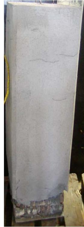
Auch dieser Putz zeigt eine eher ausgeprägte Rissneigung, obwohl der beinahe umlaufende Riss im oberen Bereich (Bild links bzw. mitte) auch auf den Umstand zurückgeführt werden kann, dass bei diesem Pfeiler eine verstärkte Krafteinleitung in die oberen Ziegelscharen nicht auszuschließen ist. (Ein mit diesem System verputzter Pfeiler war nicht Bestandteil der Salzversuche!)
