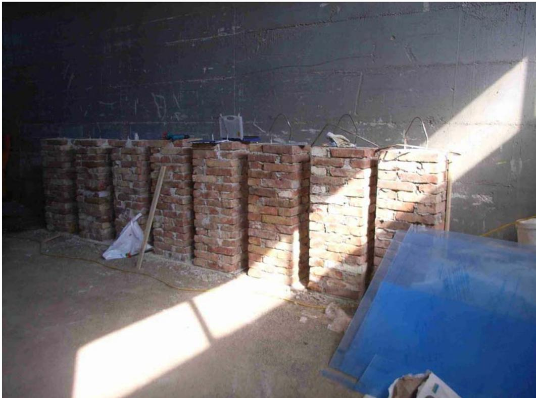
Wasserlagerung der Pfeiler für den Versuchsteil „Putzauftrag auf wassergesättigtem Mauerwerk“ in welchem die Eignung der Putze überprüft wurde, auf sehr feuchtem Mauerwerk rissfrei auszutrocknen.
